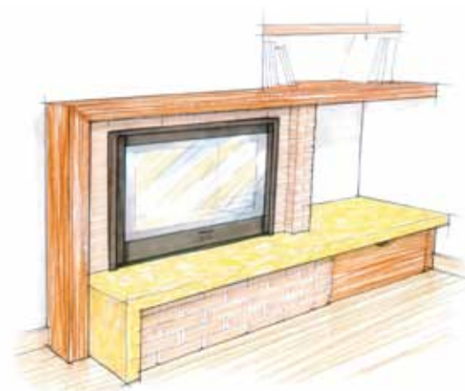
Montaggio a battuta diretta sul piano fuoco, con l'impiego di tre cornici di rifinitura fornite di serie.
