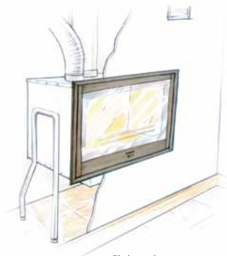
Finitura in cartongesso con l'impiego delle quattro cornici di rifinitura fornite di serie.
